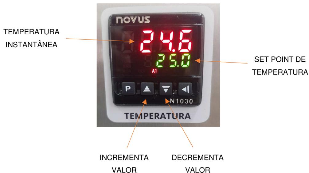
Figura 03 – Controlador de temperatura
